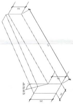
PRECAST CONCRETE DROPPER TRANSITION KERB: K3 - K2
