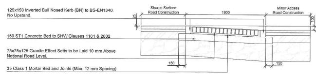
TYPICAL SCC SHARED SURFACE RAMP TRANSITION CONSTRUCTION DETAIL
