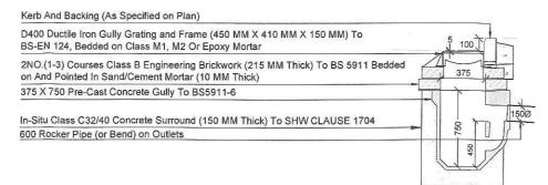
TYPICAL GULLY CONSTRUCTION DETAIL
